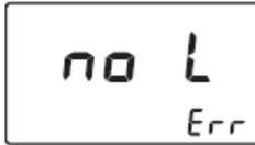
"No Light": el instrumento no puede ajustar el nivel de luz.
