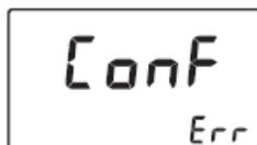
El medidor ha perdido su configuración. Póngase en contacto con su distribuidor.
