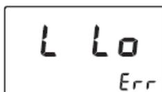
"LOW LIGHT": no hay suficiente luz para realizar una medición. Diluir la muestra en cinco ocasiones (véase "Consejos generales para una medición precisa").
